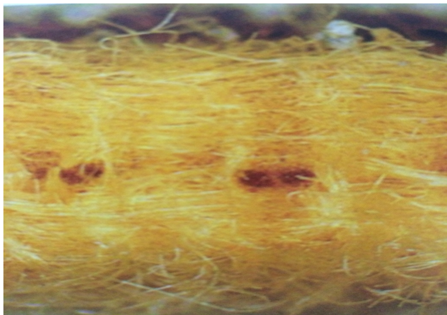
Corte de una seccion del filtro a mangas en el microscopio DESPUES de la limpieza
